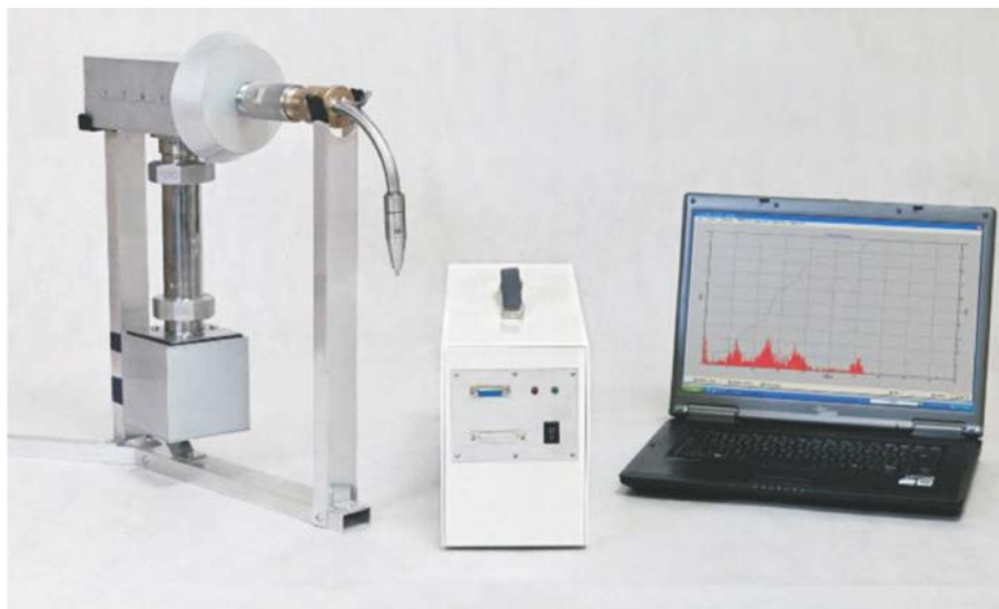
KAMIKA optinio dulkiamačio aspiracinė galvutė su zondų ir elektronikos bloku
